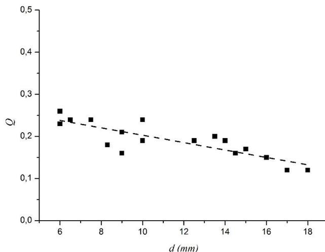
В области изменения прицельного параметра от 6 mm до 18 mm потери уменьшаются по линейному закону, представленному на графике с коэффициентом  $\gamma = -0,193$  – (0,5 б.)
