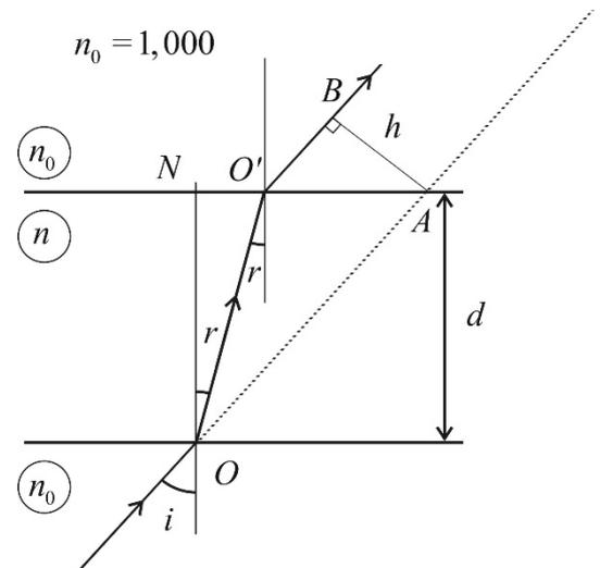
5. Линию нарисованной линейки, над которой расположена прозрачная пластинка, можно увидеть непрерывной, как на пластине, так вне ее. При наклоне пластинки линия «смещается» на расстояние, которое можно определить, сопоставив изображение с соседними линиями. (Вы можете использовать одну или несколько монет, чтобы сохранить прозрачную пластину наклонной)
